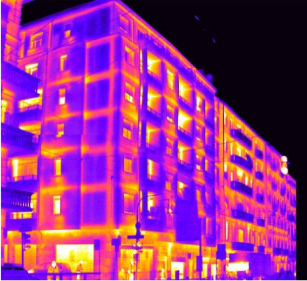
termogramma edificio del secondo dopoguerra non coibentato
