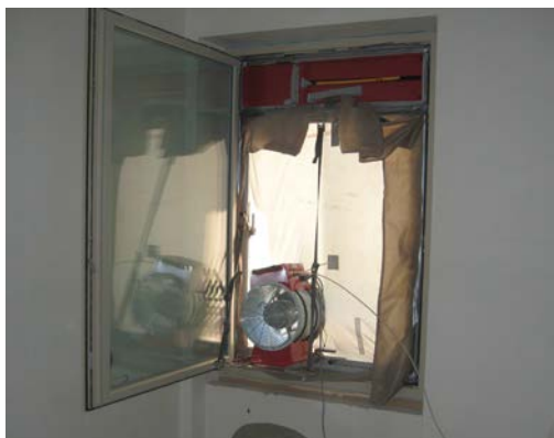
Strumentazione di misura per il Blower Door Test
